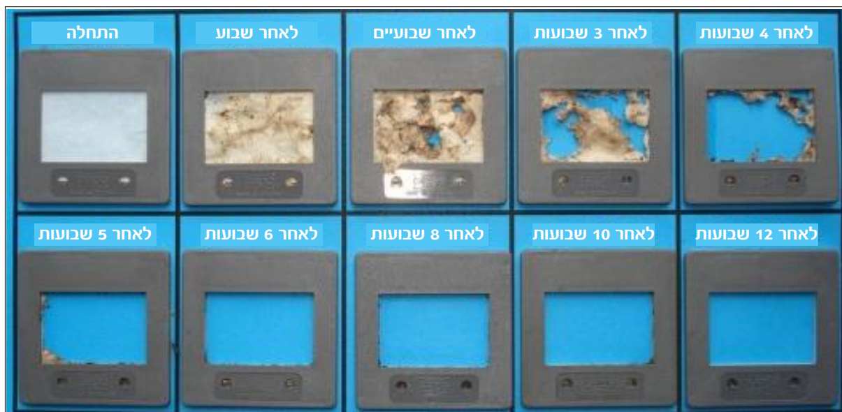
התכלות יריעה כפי שמתועד בבדיקה של התכלות ביולוגית בתנאי קומפוסט תעשייתי. מקור: (OWS) Organic Waste Systems.
